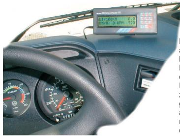
aufgewendet,um ein praxisbezogenes und bedienerfreundliches Gerät zu schaffen. Dank der kompakten Abmessung kann der diveko TripMaster problemlos in jede Fahrerkabine eingebaut werden. Ein großes zweizeiliges LED-beleuchtetes Display gestattet es dem Fahrer mühelos alle Werte abzulesen. Weiters ist der diveko TripMaster mit einer seriellen Schnittstelle ausgerüstet, so dass die Möglichkeit besteht betriebswirtschaftlich unentbehrliche Daten auszudrucken.
